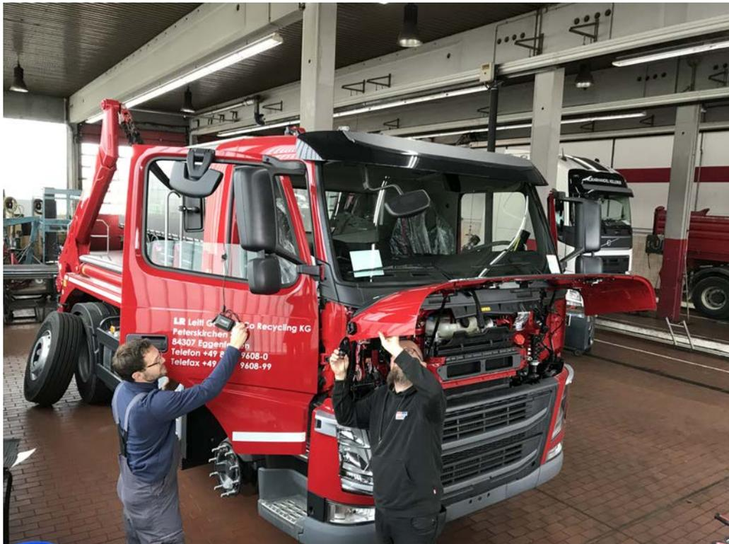
Einbau eines Abbiegeassistenzsystems durch die Werkstatt der LN Leitl Nutzfahrzeuge GmbH
